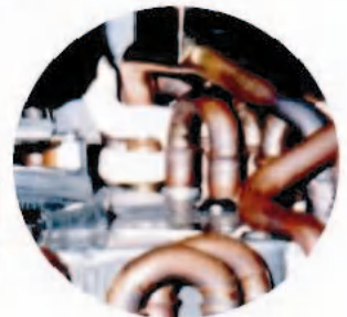
Return Bend of Heat Exchanger Uバンドロー付け
